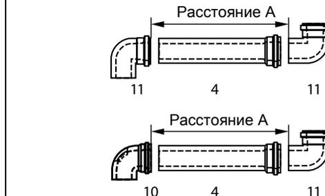
Определить длину А. Длина концентрической дымовой трубы (4) всегда на 100 мм больше длины А. Укорачивать трубу всегда следует с гладкой стороны, а **не** со стороны муфты. После укорачивания напильником обработать кромку.
