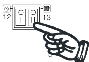
**ВАЖНО:** включение насоса должно производится до включения горелки для незамедлительного распределения тепловой энергии. В противном случае, произойдет срабатывание предохранительного термостата котла при достижении котлом максимальной температуры. Если это произойдет, необходимо будет перезапустить котел.
