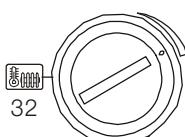
Регулировка температуры возможна в диапазоне значений от мин. 60°C и макс. 90°C.
