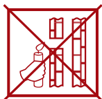
недостаточная тяга (Не используйте котел!)
