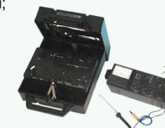
Измеритель напряжения прикосновения и тока короткого замыкания ЭКО 200
