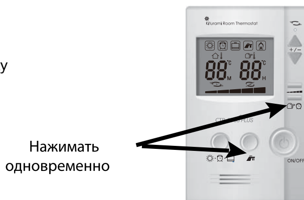
Рисунок 8. Настройка типа теплообменника
