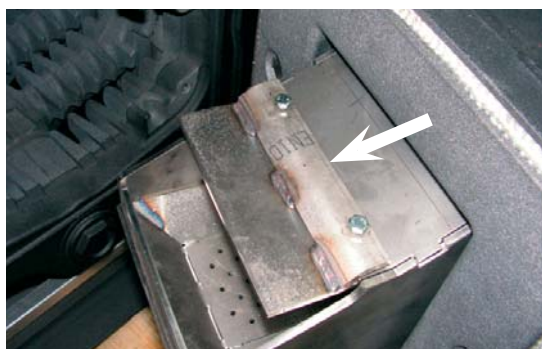
Рис. 13.12: Установка дефлектора пламени
