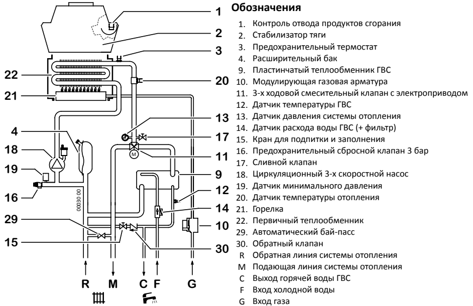
Принципиальная схема Polykraft Alpine light plus 24 C
