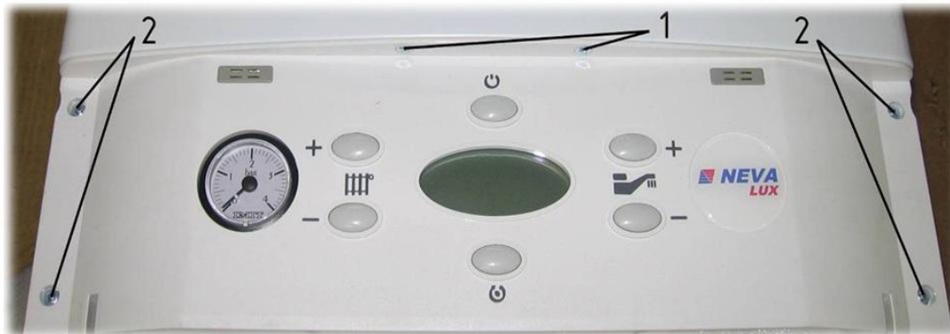
Рис. 13. Демонтаж облицовки и передней панели
