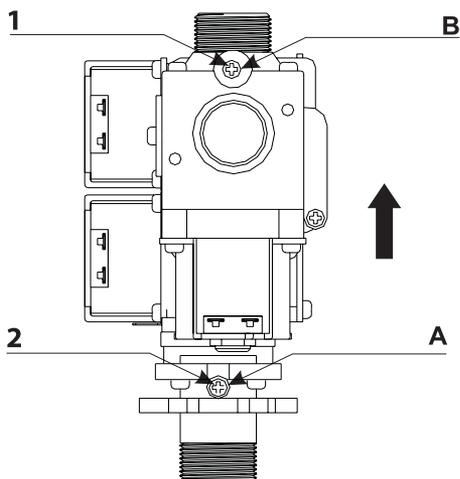
*Рис. 14. Газовый клапан
