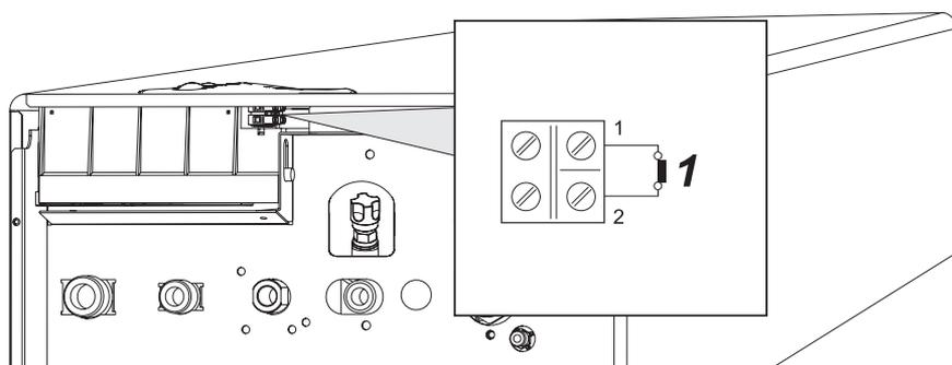
*Рис. 6 Расположение контактов для подключения комнатного термостата*
