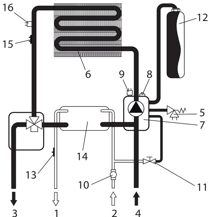
Рис. 8. Гидравлическая схема отопительной системы (контур циркуляции отопительной воды).
