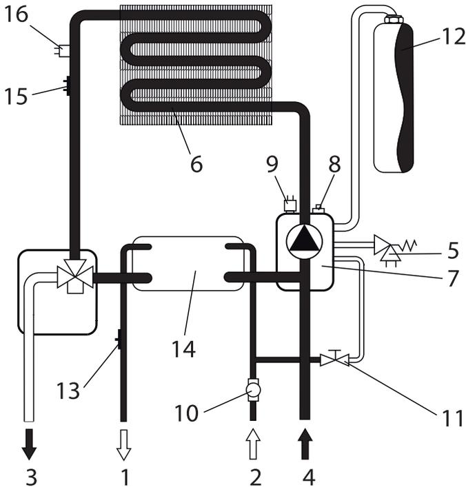
Рис. 9. Гидравлическая схема отопительной системы (контур циркуляции горячего водоснабжения)
