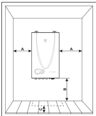
Рис. 3. размещение котла
