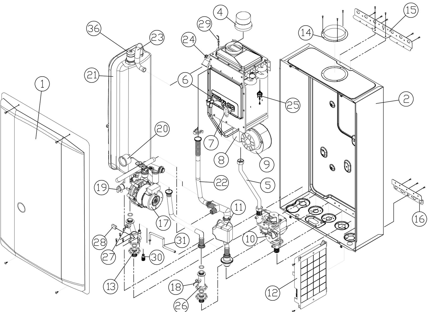
Рисунок 14. Схема котла с разнесенными частями
