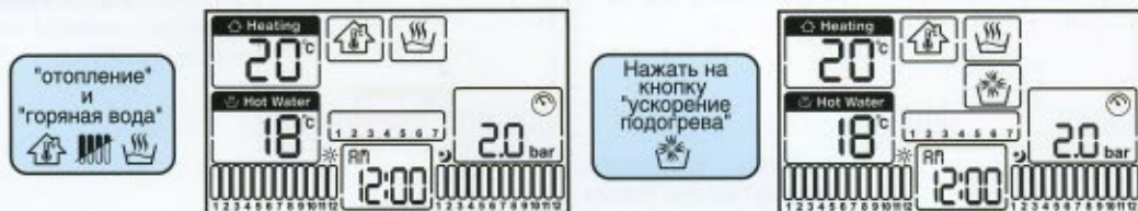
Выбран режим работы котла «отопление» и «горячая вода»
