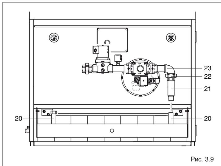
⚠ В том случае, если газовая группа установлена с левой стороны коллектора горелок, снимите и разверните газовый клапан на 180°, с тем чтобы можно было осуществлять регулировки спереди.
