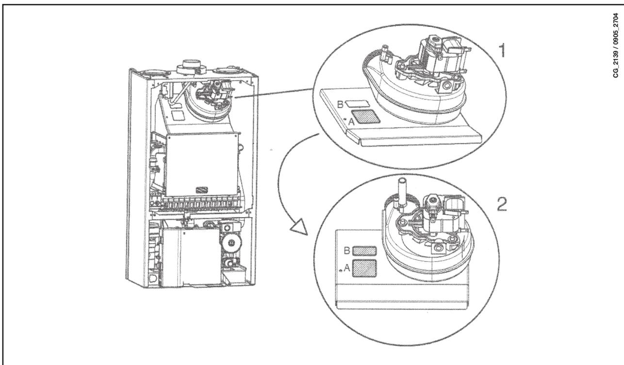
В некоторых случаях при установке дымоотводящей системы по отдельным трубам котёл может начать вибрировать. При этом возможна блокировка воздушного прессостата (код ошибки E03 на дисплее котла).
