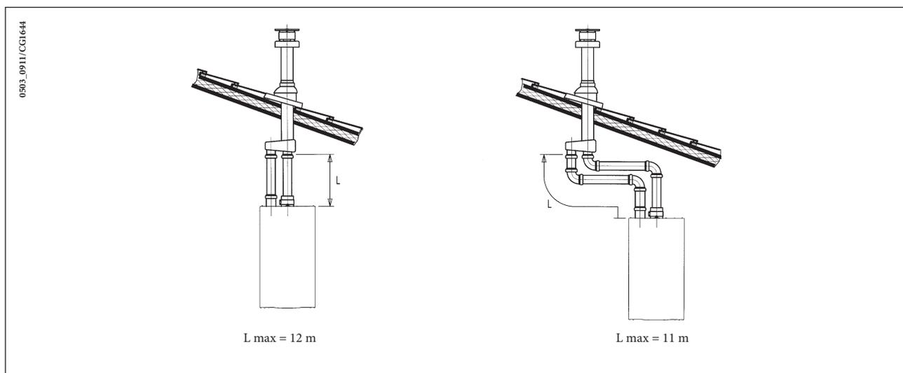
**Обратите внимание!** При установке дымохода убедитесь, что труба хорошо изолирована (напр., стекловолокном) в месте прохода трубы сквозь стену здания.
