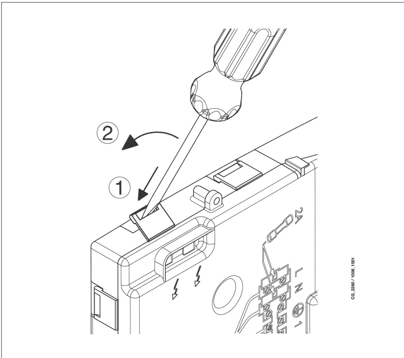
Чтобы закрыть крышку панели, надавите на пластиковые защёлки при помощи отвёртки, как показано на рисунке.
