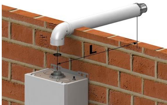
Рис. 3 Схема присоединения коаксиального дымохода Ø 100 / Ø 60 (мм) к котлу и установка диафрагмы
