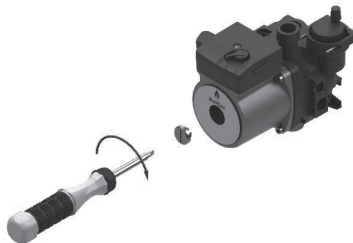
Рис. 5 Проверка циркуляционного насоса
