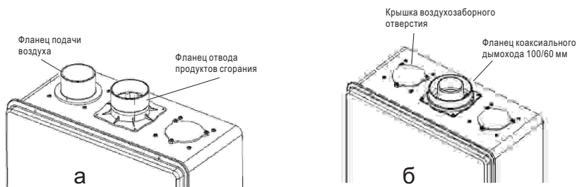
Рис. 1. Внешний вид фланцев котла Arderia:
