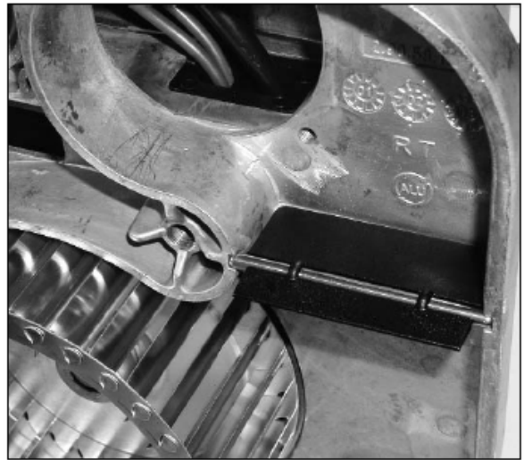
Рисунок 28 – Место установки воздушной заслонки
