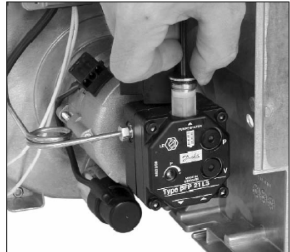
Рисунок 29 – Демонтаж топливного фильтра
